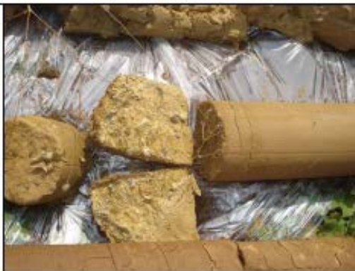
Снимки с № № 4.3 и 4.4. Глини, прахово-песъчливи, жълтокафяви с едри скални мергелни късове (el-diQ) разкрити чрез сондаж NW4 в диапазона 4,20-9,80 м
