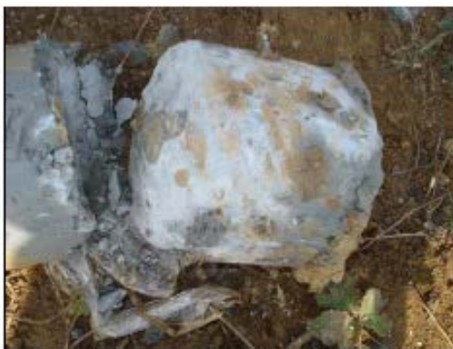
Снимки с № № 6.1 и 6.2 Изветрели мергели разкрити чрез сондаж NW4 в интервала 9,80-15,00 м
