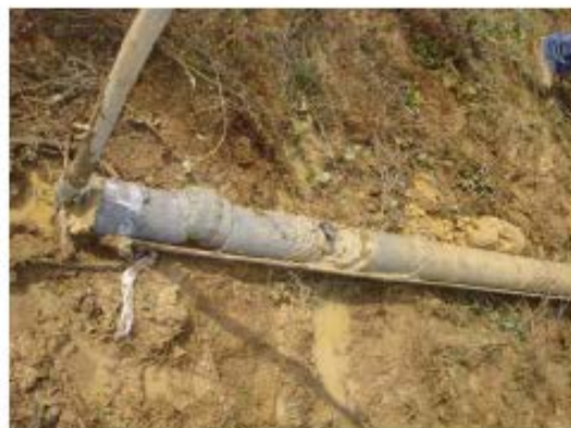
Снимки с № № 6.1 и 6.2 Изветрели мергели разкрити чрез сондаж NW4 в интервала 9,80-15,00 м
