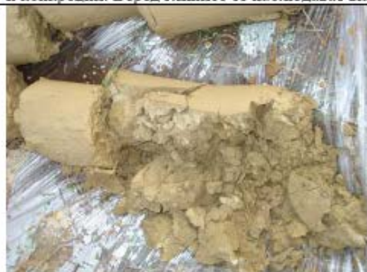
Снимки с № № 4.1 и 4.2. Глини, прахово-песъчливи, жълтокафяви с едри скални мергелни късове (el-diQ) разкрити чрез сондаж NW3 в диапазона 4,20-10,20 м
