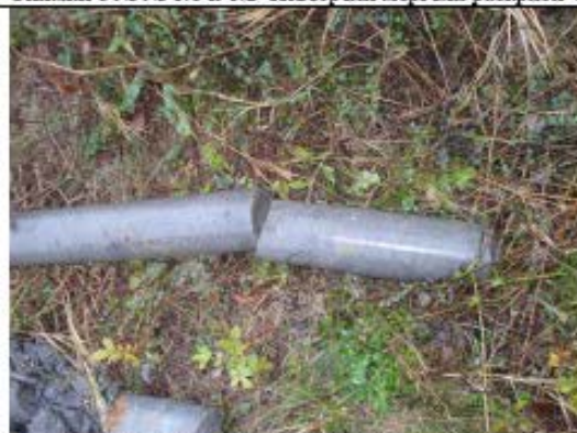
Снимки с № № 6.3 и 6.4 Свежи мергели разкрити чрез сондаж NW2 в интервала 18,20-30,00 м
