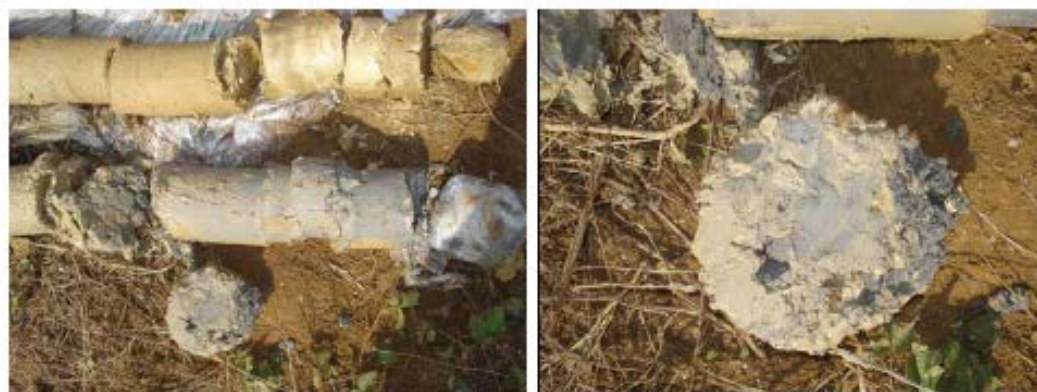
Снимки с № № 5.1 и 5.2 Глини прахови мергелни, сиви ( gK_1^{h-4} ) разкрити чрез сондаж NW1 в интервала 8.10-9.00 м
