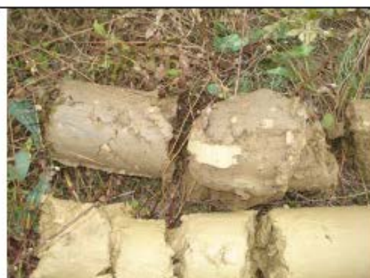
Снимка № 2.1. Почвен слой в интервала 0,00-0,70 м в сондаж NW2
