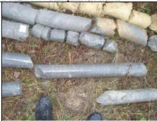
Снимки с № № 6.3 и 6.4 Свежи мергели разкрити чрез сондаж NW2 в интервала 18,20-30,00 м
