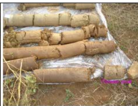
Снимка № 2.2. Почвен слой в интервала 0,00-0,20 м в сондаж NW4
