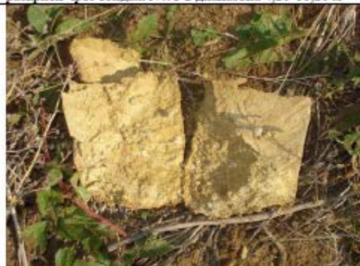
Снимки с № № 4.3 и 4.4. Глини, прахово-песъчливи, жълтокафяви с едри скални мергелни късове (el-diQ) разкрити чрез сондаж NW4 в диапазона 4,20-9,80 м
