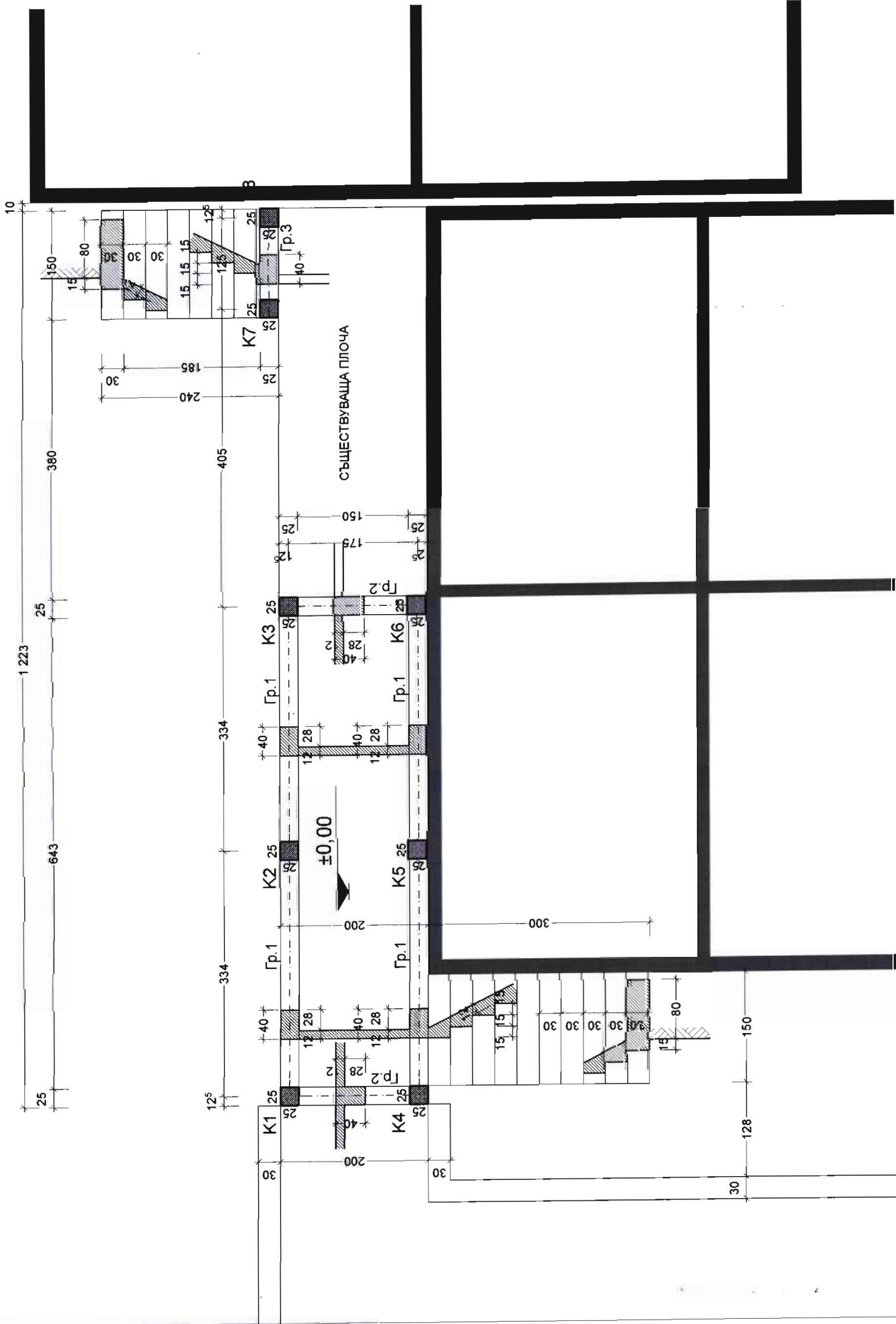
КОФРАЖЕН ПЛАН ПЛОЧА ПАСАРЕЛКА М 1:50
