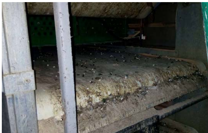
Фиг.6 Система за събиране и извеждане на тора чрез торови ленти
