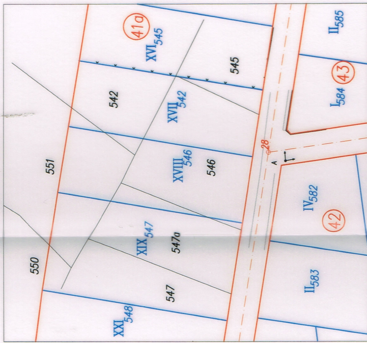
ИЗВАДКА ОТ ПЛАНА ЗА РЕГУЛАЦИЯ ОСЪВМЕСТЕН С ГЕОДЕЗИЧЕСКО ЗАСНЕМАНЕ М 1:1 000
